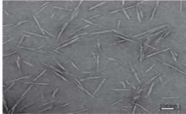
شکل الف-۴- مثالی از نانومواد سلولزی - تصویر TEM نانوبلور سلولزی (CNC) مشتق شده از خمیر چوب (براساس شکل ۱، از مرجع [391]).
