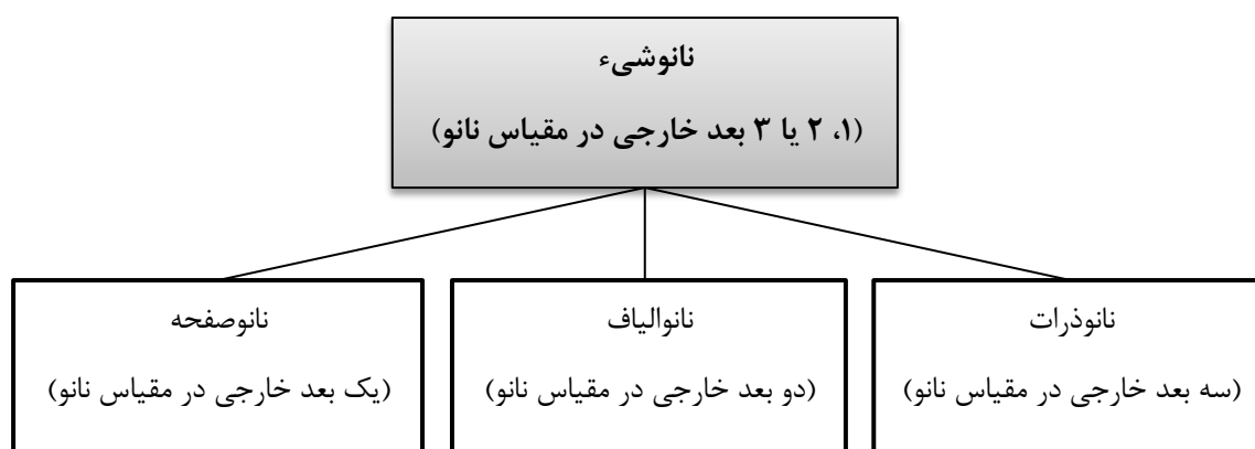
شکل ۲- بخشی از سلسله مراتب اصطلاحات مرتبط با نانواشیاء (استاندارد ملی ایران- ایزو شماره ۱- ۸۰۰۰۴: سال
