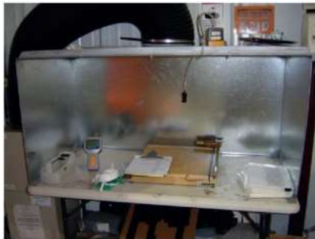
شکل ۷- هود محصورکننده با خروجی مجهز به فیلتر HEPA (برگرفته از گزارش NIOSH «پیشرفت به سوی نانو فناوری ایمن در محیط کار» [278])
